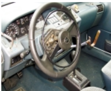
Figure 8 - Cercle accélérateur au volant et levier de frein (paraplégique).
