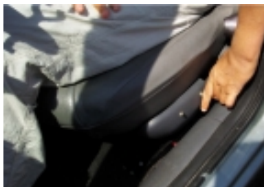
Figure 6 - Commande électrique du siège conducteur.
